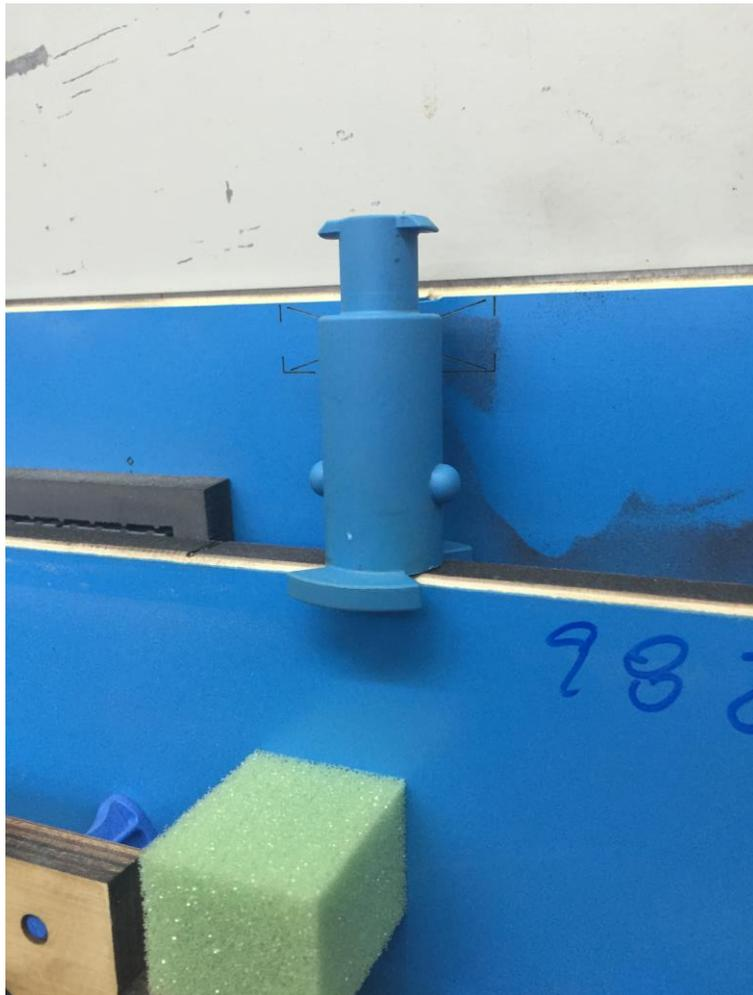
**Der CPS-Easy-Fix besteht aus nur einem Teil und verbindet ohne jede Schraube oder benötigtes Werkzeug die Ausbrechformen zu Transport oder Lagerung.**
